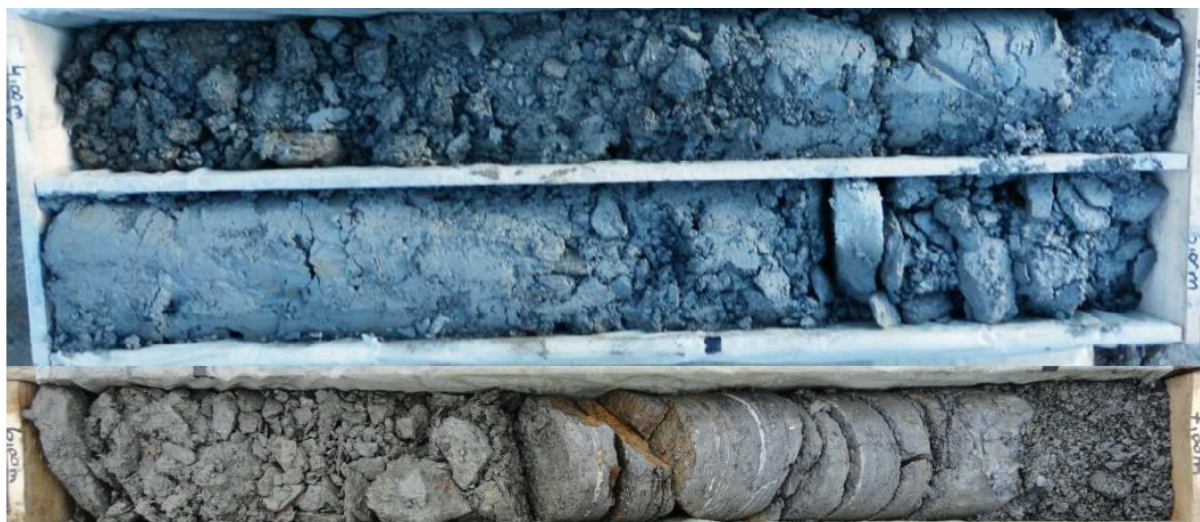
Abbildung 20: Scherzone im orographisch linken Kernwandeinbindebereich
