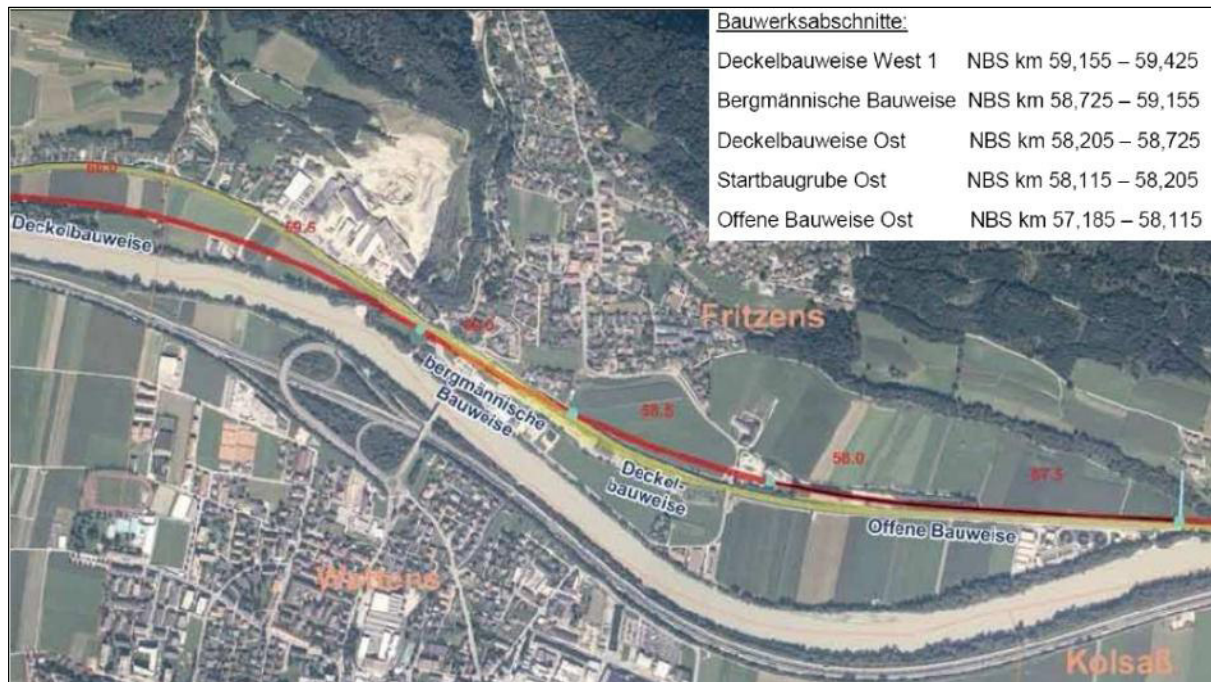
Abbildung 29: Losübersicht und Bauweisen Los H7 Ost (Fritzens)
