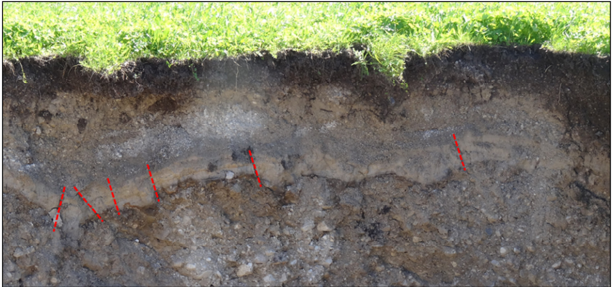
Abb. 3 Versetzungen in den jüngsten Schichten durch aktive Auslaugung im Untergrund
