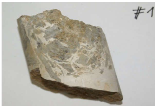
Abbildung 21: Injizierte, steilstehende Kluft
